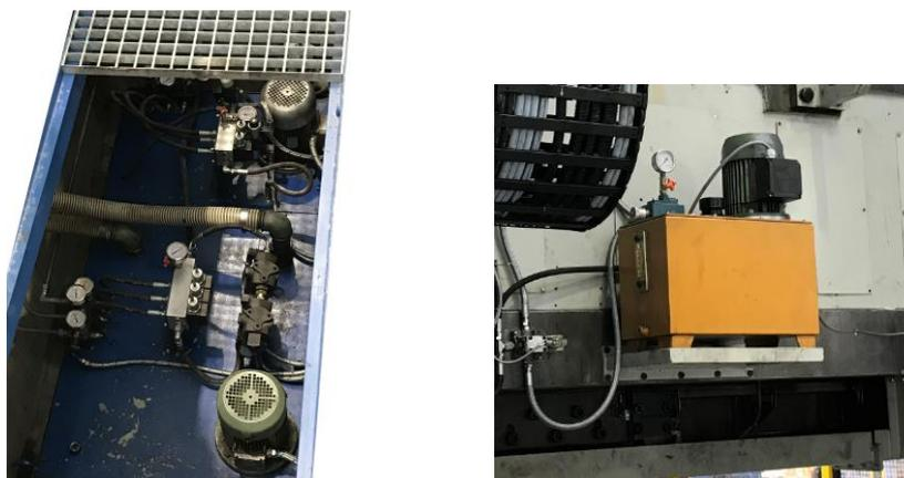
**Figura 1.2.1 – Centralina oleodinamica principale (a sinistra), centralina oleodinamica traversa mobile (a destra)**
