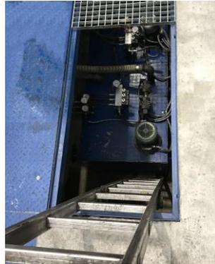
**Figura 1.3.1 – Centralina di lubrificazione**
