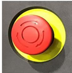
**Figura 1.5.4 – Pulsante di arresto di emergenza del pannello operatore.**
