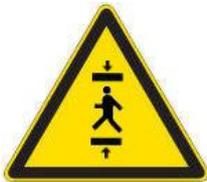
**Se le operazioni di sollevamento, trasporto e fissaggio delle parti della macchina vengono eseguite senza seguire le prescrizioni del manuale e da personale non qualificato, oltre a danneggiare la macchina, si genera sicuramente un pericolo di schiacciamento e pericolo d'urto, sia per chi esegue l'operazione e sia per tutte le persone in prossimità della zona delle operazioni.**
