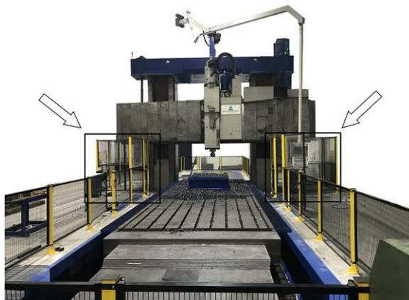
**Figura 1.2.2 – Postazione di comando dell'operatore**
